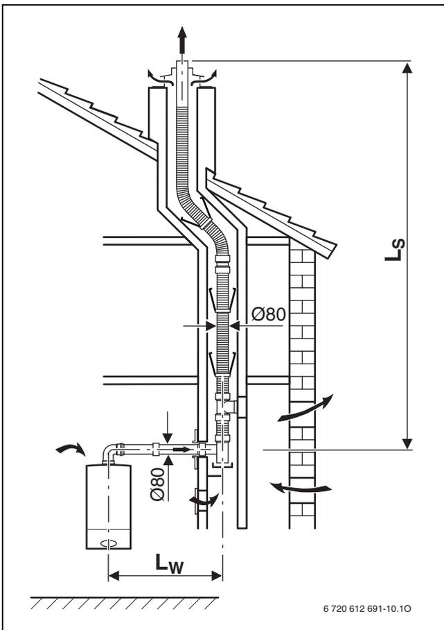
Fig. 10 Tipologia di scarico B<sub>23</sub>
