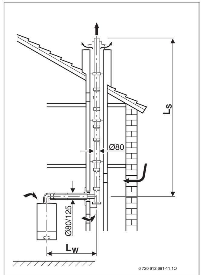
Fig. 11 Tipologia di scarico B<sub>33</sub>
